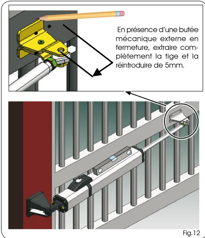
10. Fermer le vantail du portail et monter la fixation avant sur la tige conformément à la Fig. 11 réf. ②.
