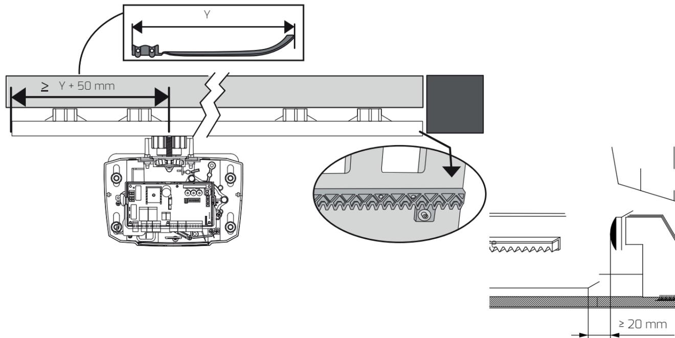
Positionner les pattes de fins de course en gardant une marge de 2 cm avant que le portail arrive en butée. Le doigt de fin de course doit être bien couché. Attention la première impulsion après la mise sous tension est une ouverture.
