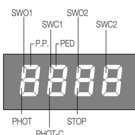
Jedem Eingang ist ein Displaysegment zugeteilt, das bei der Aktivierung laut nachstehendem Schema aufleuchtet
