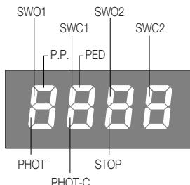
Każde wejście ma przypisany określony segment na wyświetlaczu, który zostaje podświetlony w przypadku aktywowania danego wejścia zgodnie z podanym poniżej schematem. Wejścia N.Z. wyświetlane są przez segmenty pionowe. Wejścia N.O. wyświetlane są przez segmenty poziome. Centralka wyświetla komunikaty AMP1 lub AMP2 w przypadku zadziałania czujnika amperometrycznego zapobiegającego przygnieceniu.
