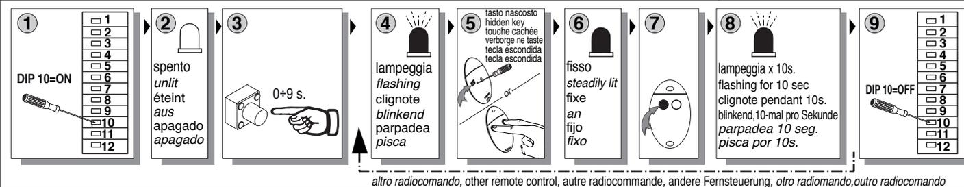
PROGRAMMAZIONE TRASMETTITORI AUTOMATICA, AUTOMATIC TRANSMITTER PROGRAMMING, PROGRAMMATION AUTOMATIQUE EMETTEURS, PROGRAMMIERUNG DER SENDER EN AUTOMATISCH, AUTOMATISCHE PROGRAMMIERUNG DER SENDER, PROGRAMAÇÃO AUTOMÁTICA DOS TRANSMISORES.
