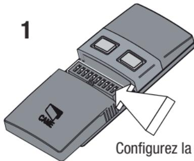
Configurez la clé sur le Dip Switch de l'émetteur
