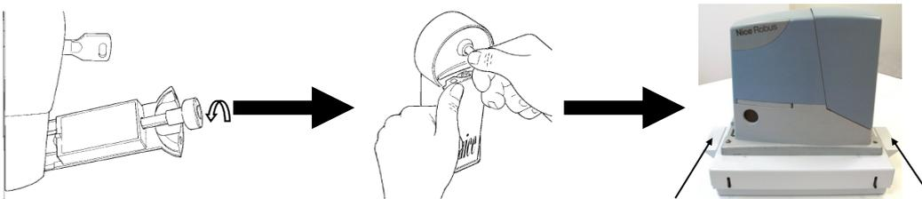
Pour verrouiller le moteur, dévisser la molette, refermer la trappe du **KIO** complètement. Tirer vers le haut les deux poignées de la **platine de déverrouillage**. A ce stade le portail est verrouillé.
