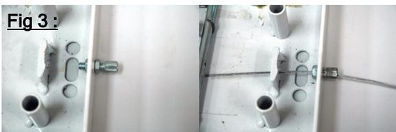
Visser la butée d'arrêt de la gaine sur la platine
