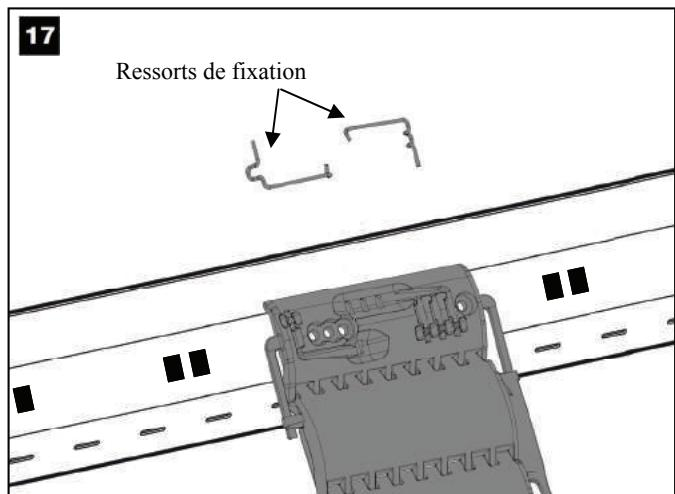
*S'assurer de la parfaite fixation des verrous automatiques de sécurité sur le tube en effectuant une traction sur ceux-ci.*
