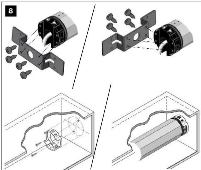
**04. Fixation de la tête moteur.** - Visser le support **d** avec les vis fournies en centrant sur la tête moteur. Fixer l'ensemble sur le flanc du coffre (**fig. 8**). Si le coffre du volet est équipé de flasques fixes, il est possible qu'il soit nécessaire d'y fixer le support en enfilant le tube au travers (**fig. 9**). Il est aussi possible de fixer la tête moteur directement sur une patte de fixation présente dans le coffre.
