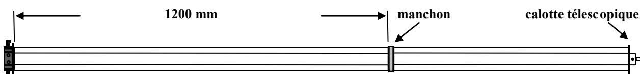
**03. Si une seule longueur de tube suffit, le couper à la longueur nécessaire.**—Couper le tube avec précaution sur la base de la longueur du tube déterminée précédemment (voir PHASE 3), sans déformer le profil à l'extrémité.
