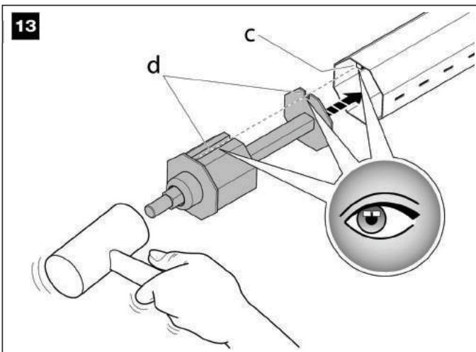
**09.** Enfiler le roulement dans son support (fig. 14) en allongeant si nécessaire l'axe télescopique de la calotte après avoir desserré la vis noire à six pans creux. Penser à la resserrer après réglage
