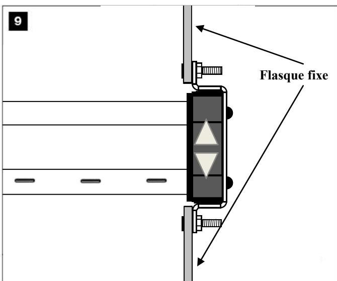
**05. Choisir le côté où positionner la tête du moteur.** - Pour des raisons de sécurité, la tête du moteur et le câble d'alimentation doivent être positionnés du côté où se trouve la ligne électrique d'alimentation et où l'interrupteur de commande sera positionné successivement (**fig. 10**). **Attention** – à l'intérieur du caisson le câble d'alimentation doit être placé loin des parties en mouvement.
