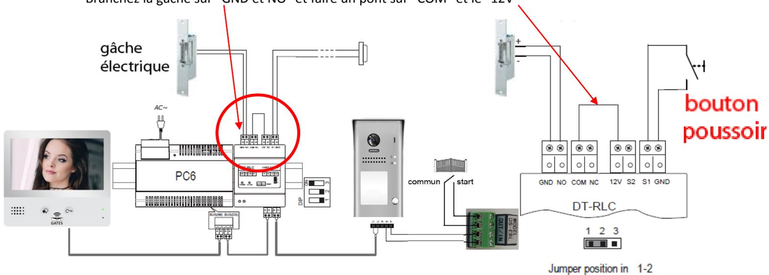
Branchez les bornes "START" et "COM" de l'automatisme sur "OUT et OUT" du relais DS-ERL
