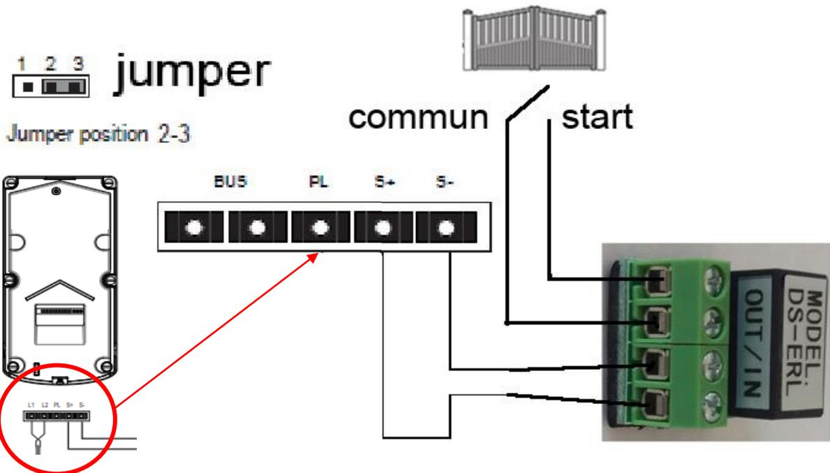
**CAS N°2 : branchement d'un automate sur boîtier relais KDT-RLC et d'une gâche électrique sur platine de rue KDT607C**
