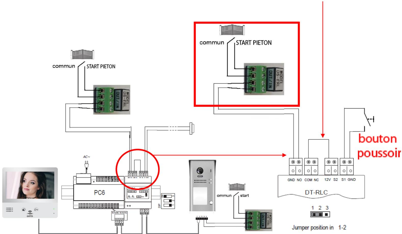
Branchez les bornes "START" et "COM" de l'automatisme sur "OUT et OUT" du relais DS-ERL
