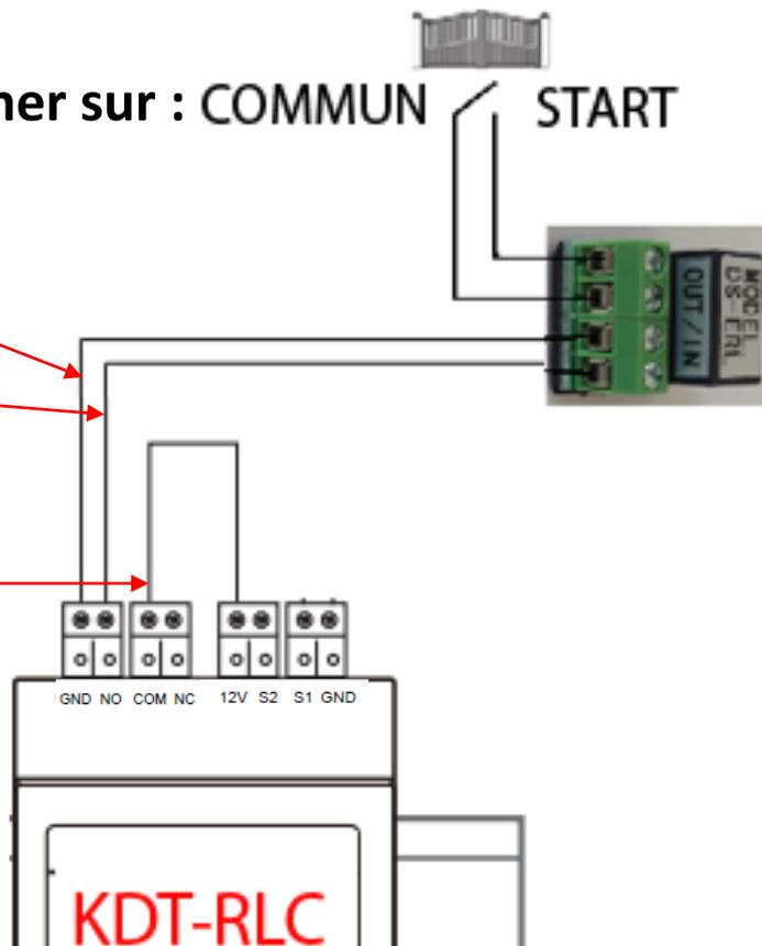
CAS N°3 : branchement d'un automate sur boîtier relais KDT-RLC et d'une ouverture piéton sur platine de rue KDT607C
