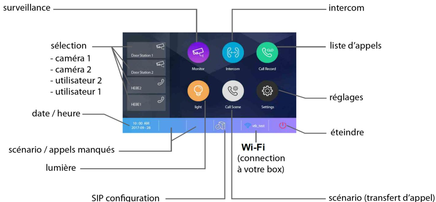
**surveillance** : permet une sélection des caméras par nom
