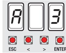
2. Sélectionner 1 et appuyer sur ENTER pour confirmer l'opération de réglage automatique de la course.
