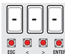
4. Maintenir enfoncée la touche signalée par la flèche < et s'assurer que l'automatisme effectue bien une manœuvre d'ouverture.
