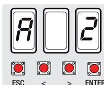
2. Sélectionner 1 pour activer le test. Appuyer sur ENTER pour confirmer...
