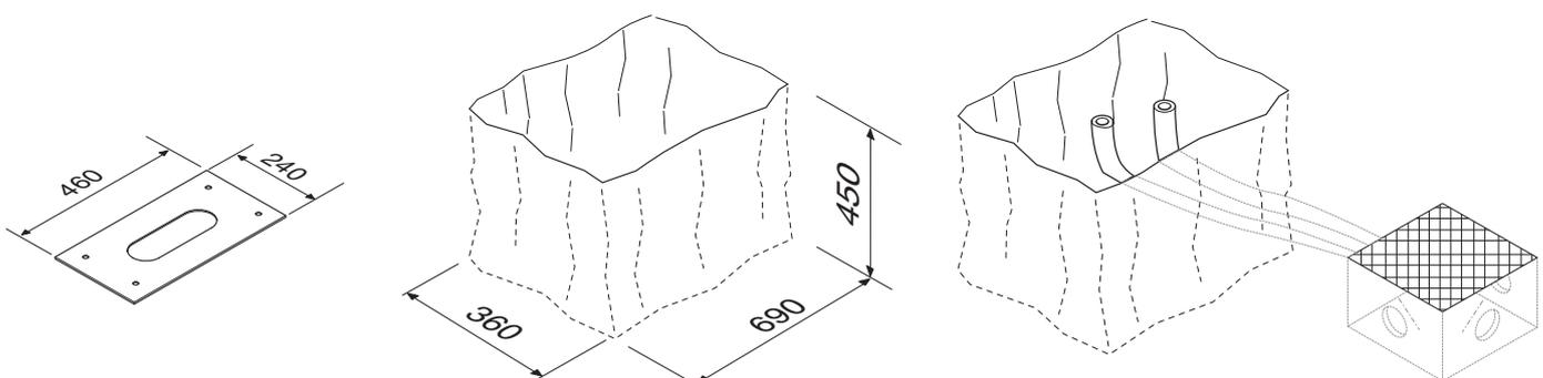
Préparer un coffrage plus grand que la plaque de fixation et l'introduire dans le trou.
