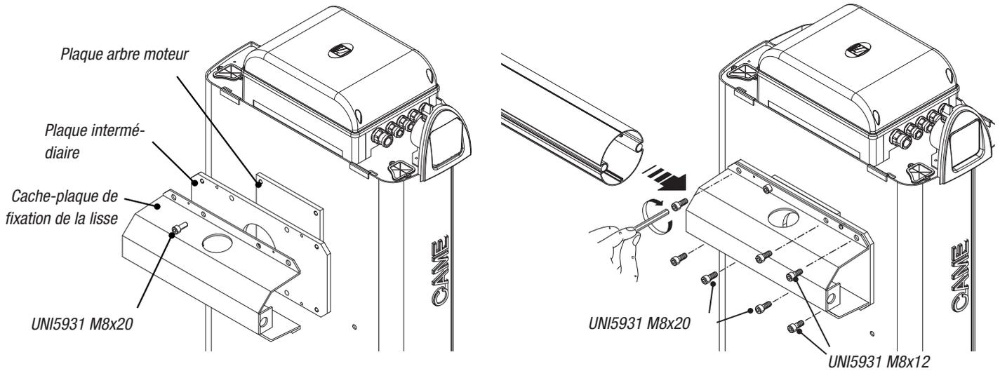
Couper les profilés couvre-joint selon la longueur nécessaire et les introduire dans les rainures de la lisse des deux côtés. Fixer le couvercle pour lisse à l'aide des vis.
