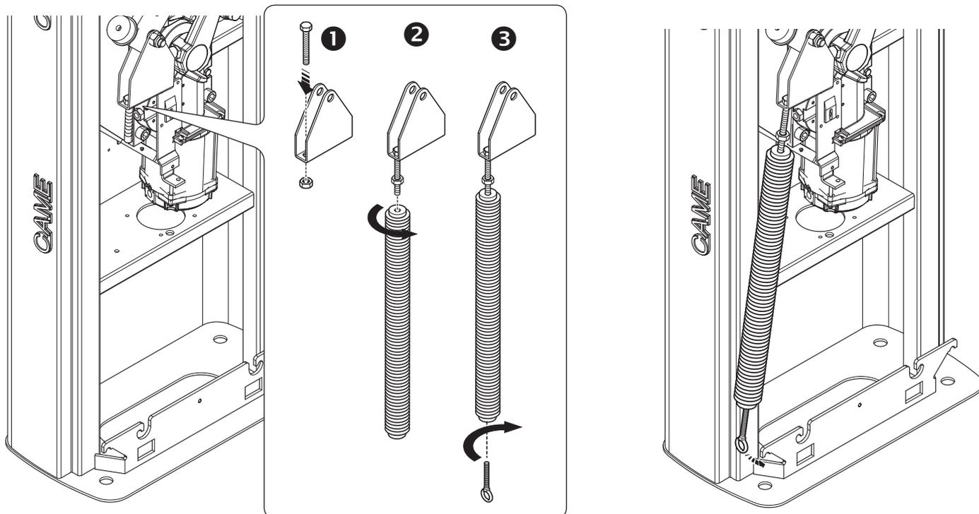
Débloquer le motoréducteur et tourner manuellement le ressort pour augmenter ou réduire la traction. La lisse doit se stabiliser à 45°.
