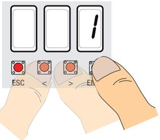
3. ... il y aura clignotement, pendant quelques secondes, d'un numéro disponible de 1 à 25 ; ce numéro sera attribué à l'utilisateur après l'envoi du code au moyen de l'émetteur ou d'un autre dispositif de commande (capteur, lecteur cartes ou sélecteur à clavier).
