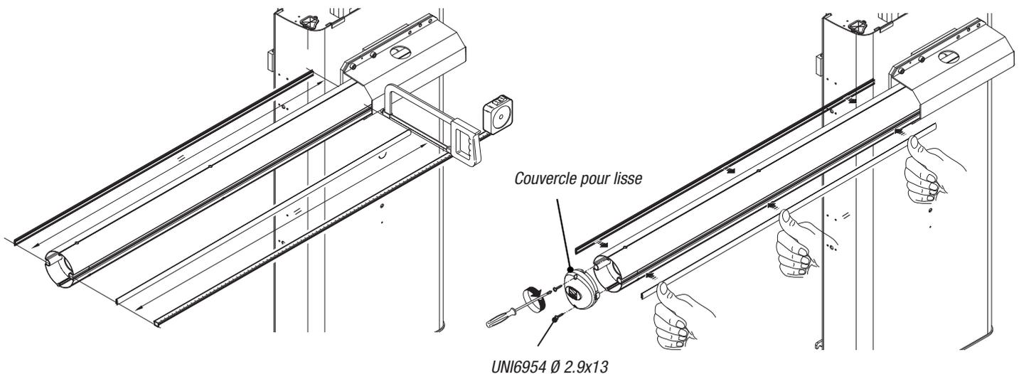
Appliquer le carter de protection anti-cisaillement sur le cache-plaque de fixation de la lisse et le fixer à l'aide des vis.
