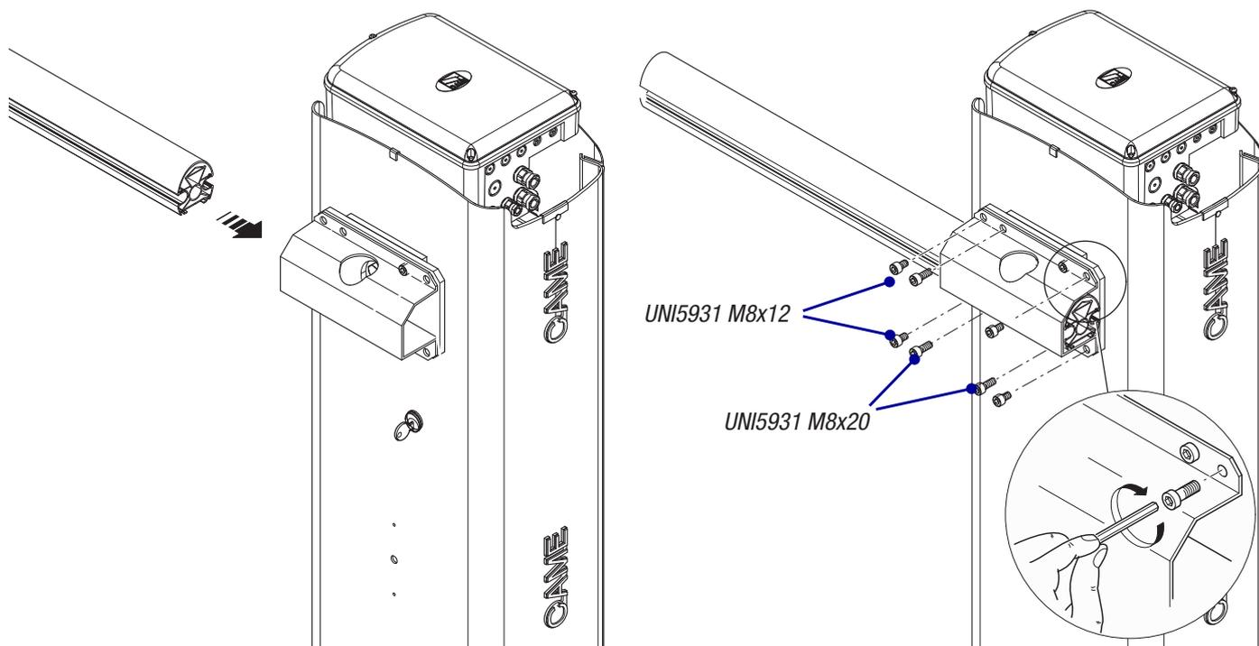
Couper les profilés couvre-joint selon la longueur nécessaire et les introduire dans les rainures de la lisse des deux côtés **1 2**.
