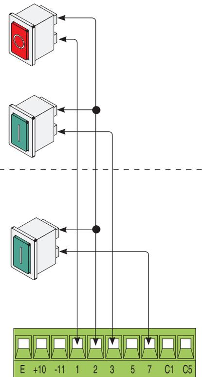
Fonction OUVERTURE UNIQUEMENT ou OUVERTURE-FERMETURE-INVERSION (pas-à-pas) depuis un dispositif de commande (contact NO), voir DIP 2.
