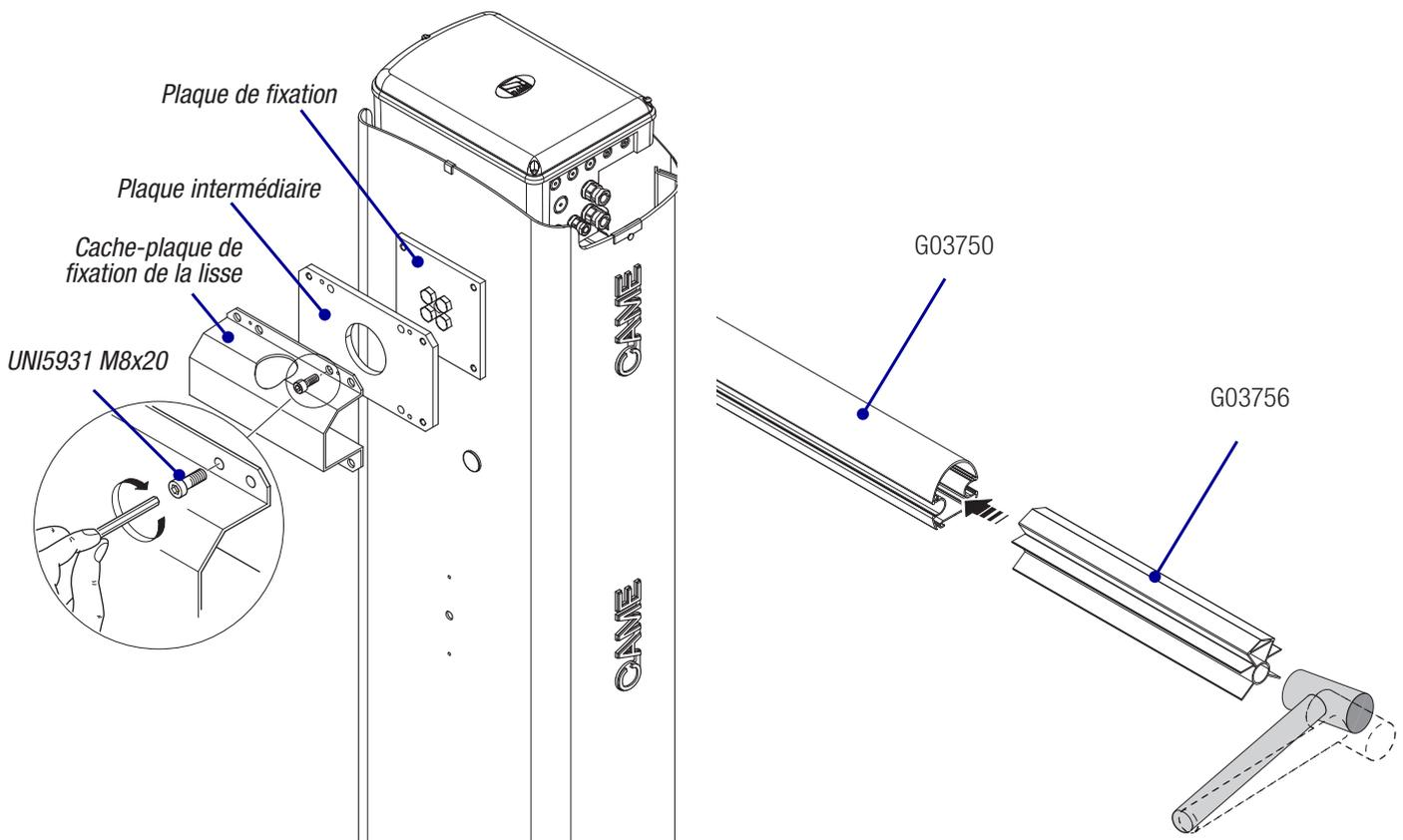
Introduire la lisse dans le cache-plaque et la fixer à l'aide des vis.
