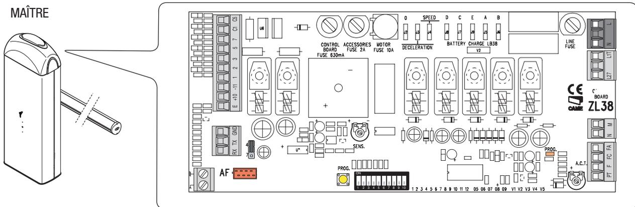
Sur la carte électronique de la barrière **ESCLAVE**, connecter l'alimentation sur L-N, le feu clignotant sur 10-E, positionner le commutateur DIP 7 sur ON et régler la vitesse de marche et des ralentissements comme sur la carte électronique de la barrière **MAÎTRE**.
