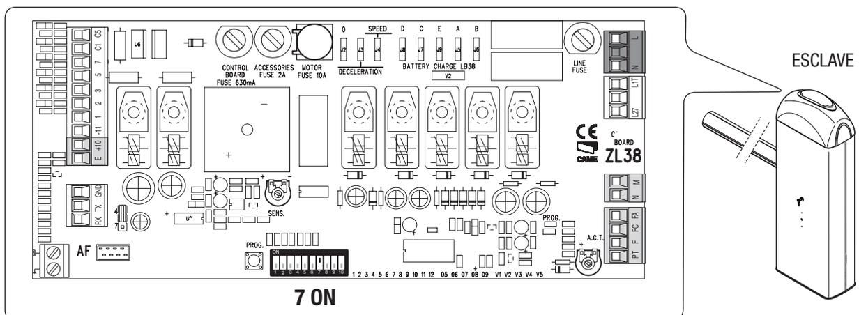
Connecter les deux cartes à l'aide des bornes RX-TX-GND comme indiqué sur la figure.
