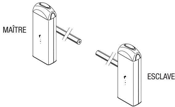
Effectuer, sur la carte électronique de la barrière **MAÎTRE**, les branchements électriques, l'activation de la commande radio, la programmation des fonctions et les réglages.
