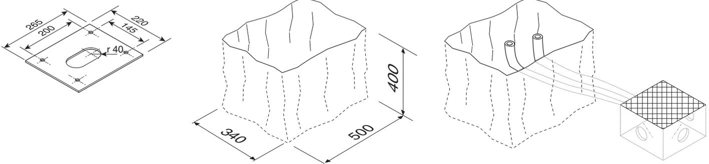
Préparer un coffrage plus grand que la plaque de fixation et l'introduire dans le trou.
