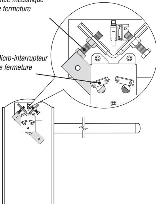
*Butée mécanique d'ouverture*
