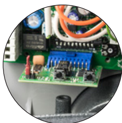
CARTE RADIO RÉCEPTRICE OPEN COLLECTOR
