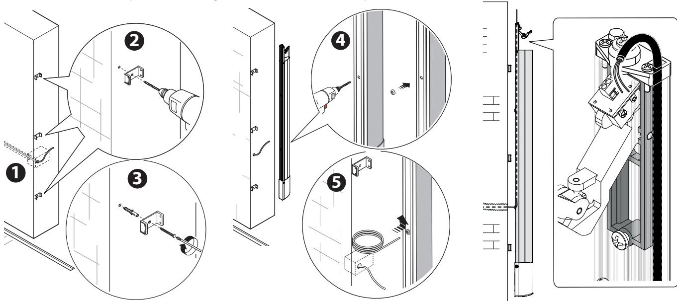
Positionner le bord sensible sur les brides (avec mécanisme de support du micro-interrupteur orienté vers le haut), percer sur les côtés du profilé à l'aide d'une mèche d'un diamètre de  $\varnothing$  2,5 mm ⑥ et le fixer à l'aide des vis UNI 6954  $\varnothing$  2,9x13 ⑦.
